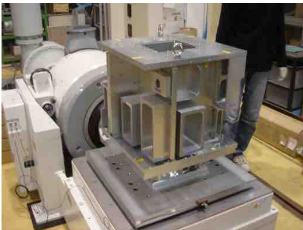
図1 QSAT-EOS 地上試験用構造体
