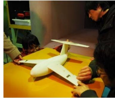
図5 地面効果翼機 風洞試験
