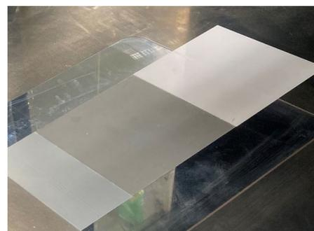
矩形測定面によるリブレット計測
