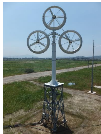
図1 . 9kW マルチレンズ風車(3基構成、北九州市ひびきで認証取得のため実験中)(系統連系)
