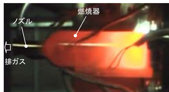
(b) 燃焼器およびノズル(燃焼試験時)
