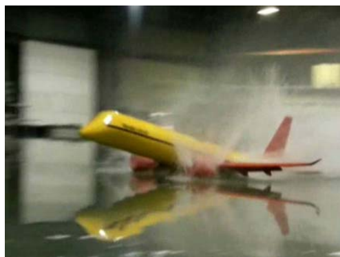
非常着水模型試験による着水時安全性評価
