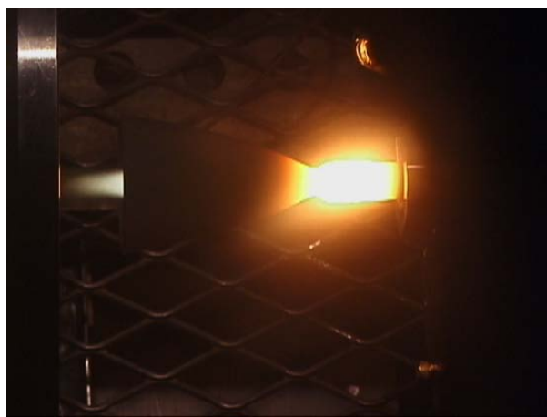
写真5 スラスタ燃焼試験（20N二液スラスタ）
