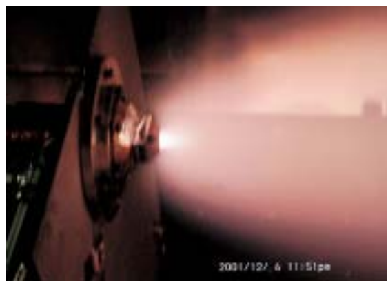
写真2 DCアークジェットスラスタ-性能実験
