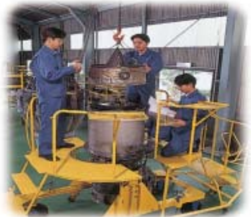
写真 5 ジェットエンジンの分解検査実習
