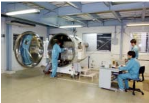
写真3 DCアークジェット実験装置真空チャンバ-
